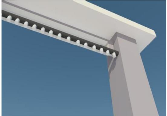
Gambar penyemprot desinfektan
